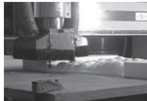
Umsetzung der Styroporplatten auf der CNC Fräse
