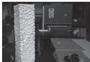
Zusammensetzen und Lackieren der Styroporplatten
